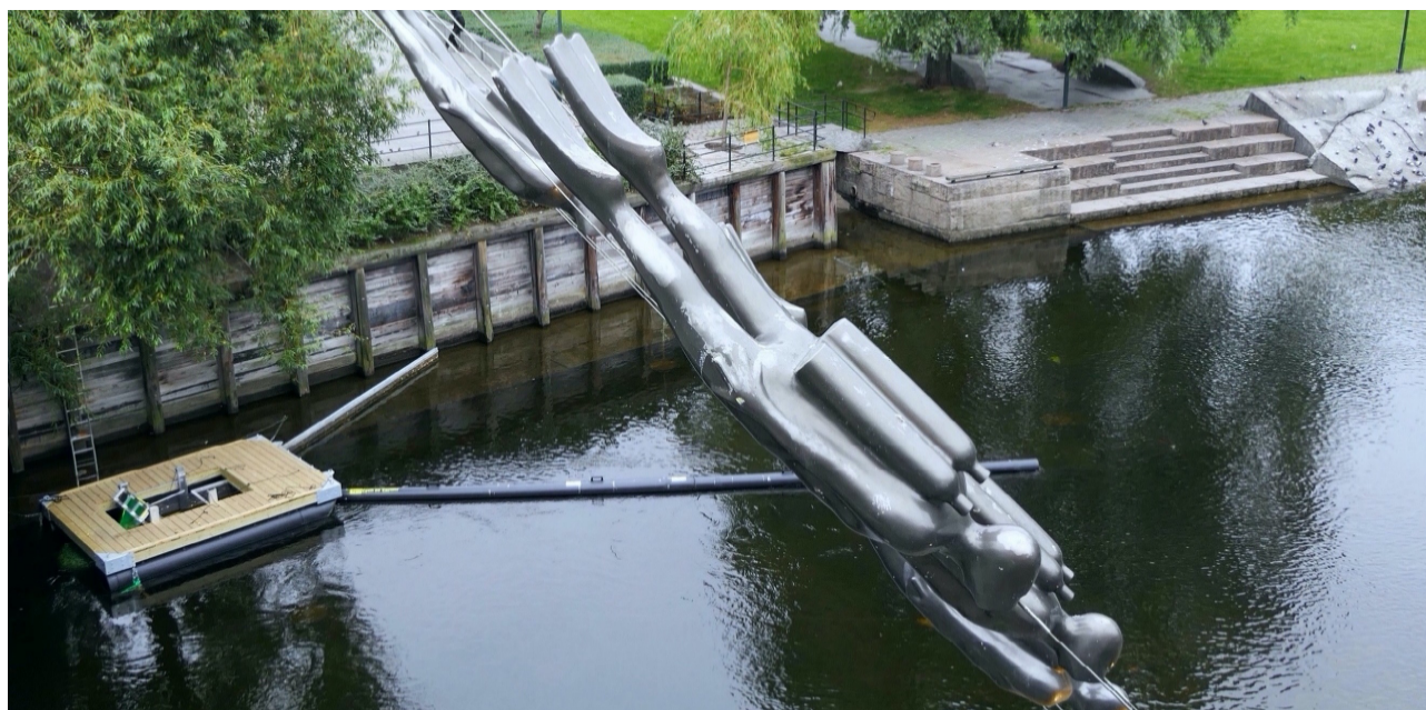
Figur 1 TrashTrawl med ledelensene og oppsamlingsnett plassert i midten av flytebryggen. Søppelopsamleren er utplassert ved Vaterland i nedre del av Akerselva. (Foto: SpillTec).
