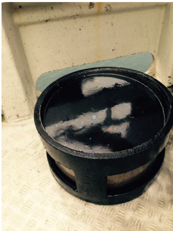
Figur 5: Olje i sikteprøve av sediment. Oljen tettet igjen hull i sikt og vanskeliggjorde våtsikting av prøver til bunndyrspreparater (foto: SALT).
